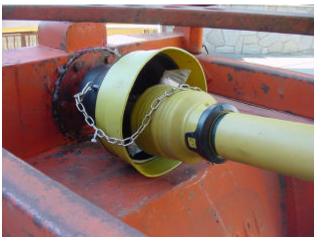
Sistema di trasmissione del moto ricondizionato con albero cardanico protetto, cuffia conforme, catenelle antirotazione e supporto a riposo
