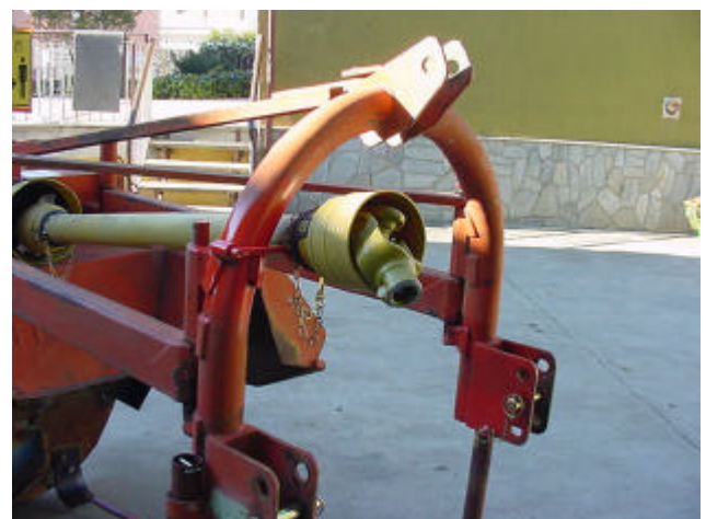
Sistema di trasmissione del moto ricondizionato con albero cardanico protetto, cuffia conforme, catenelle antirotazione e supporto a riposo
